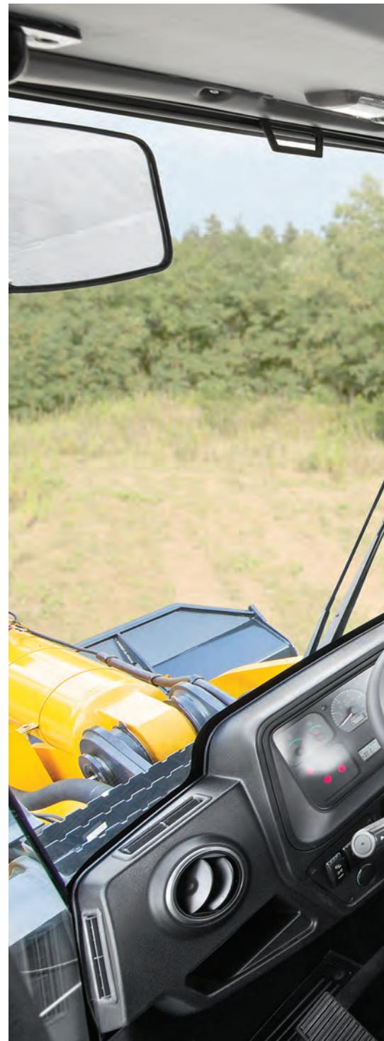
Kabina štiti rukovaoca od buke i vibracija i ima dobru ventilaciju. Ima naprednu kontrolu klime sa sezonskim podešavanjem i hermetički je zatvorena kako bi sprečila ulazak prašine na radno mesto.
